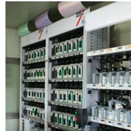
[퍼머크론* 교반기, 10년이 넘었음에도 최근에 설치한 하이텍 교반기와 청결상태에 큰 차이가 없다]
